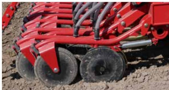
Тонкая конструкция сошника CD обеспечивает перемещение только небольшого количества грунта. Благодаря этому уменьшается давление и достигается правильная глубина посева. Таким образом, прикатывающим каткам можно передать больше давления сошников, в результате чего вы получите равномерное внесение семян.
