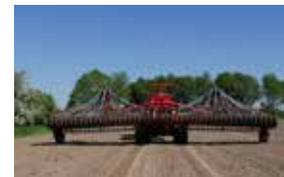
Благодаря крепким осям и плавающим колесам, машину легко буксировать. Она позволяет транспортировку со скоростью до 40 км/ч. С шириной 3 метра и высотой 4 метра, ее размеры соответствуют европейским нормам регулирования дорожного движения. Размеры машины также позволяют проходить под мостами и туннелями.
