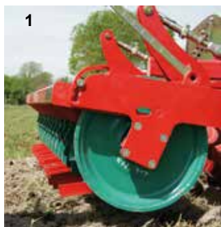
Actirack и Actiring: 4 различных давления могут быть приложены к опорным рамам в зависимости от почвы и требуемой степени обработки.
