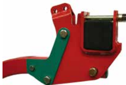
Полая стойка с сечением 70x40мм
