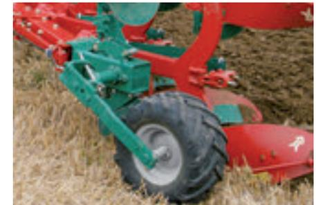
**Задние опорные и транспортировочные колеса с гидравлической регулировкой глубины**
