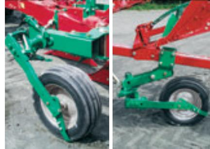
**Опорные и транспортные колеса для установки на раму**
