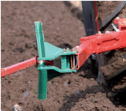
Рычаг уплотнителя, соединенный с почвоуплотнителем
