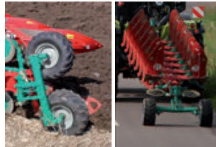
**Задние опорные колеса и сдвоенные колеса для транспортировки**
