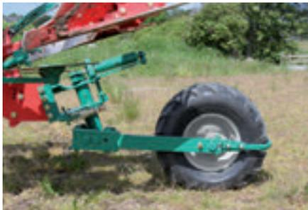
**Задние опорные и транспортировочные колеса**
