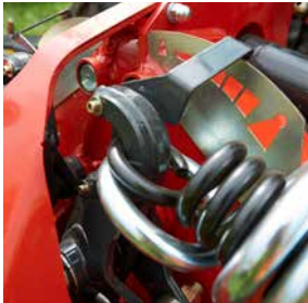
Подвесные пружины с гидравлическим устройством регулировки давления на грунт. (опционально)
