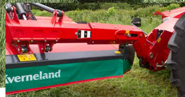
На моделях Vario регулировка перекрытия и эффективной рабочей ширины выполняется гидравлическим устройством.
