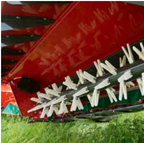
Эффективная плющилка, оснащенная нейлоновыми пальцами.
