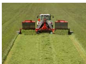
Укладка в расстил по всей ширине
