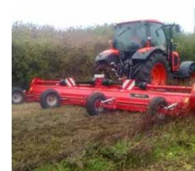
Доступны по заказу полуповоротные колеса (слой армирующих волокон 10/8,0 x 12,8), обеспечивают стабильность и постоянную рабочую глубину во время работ.
