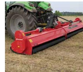
Рабочая ширина от 560 до 640 см. Стандартный каток (Ø245мм) расположен близко к профилю для обеспечения эффекта самоочистки.
