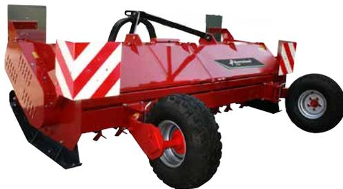
Полуповоротные колеса (слой армирующих волокон 10/8,0 x 12,8) в стандартной комплектации обеспечивают хорошую устойчивость и постоянную рабочую глубину машины FXZ во время полевых работ.
