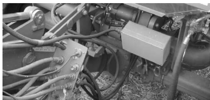
Рис. 17 – Вид на панель соединений РВД гидросистемы агрегата
