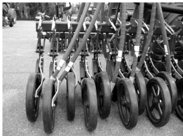
Рис. 10 – Двухдисковые сошники с прикатывающими колесами
