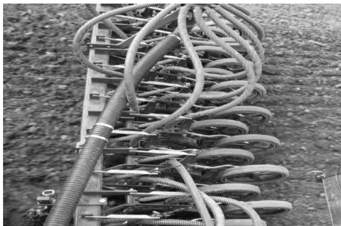
Рис. 8 – Фрагмент сошникового бруса
