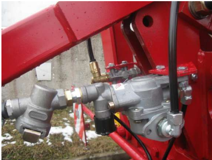
Рис.22в - Водухораспределитель с клапаном растормаживания
