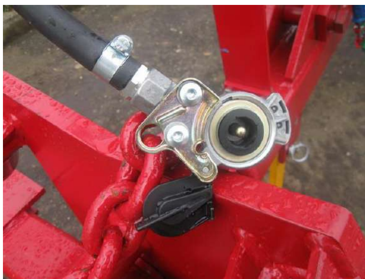
Рис. 22б - Соединительная головка с чёрной крышкой
