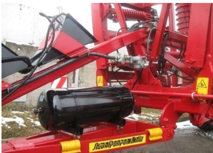
Рис. 21 – Воздухораспределитель с магистральным фильтром и ресивером
