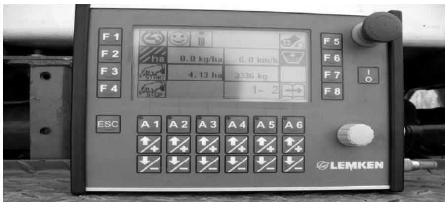
Рис. 13 – Индикаторная панель системы контроля и управления
