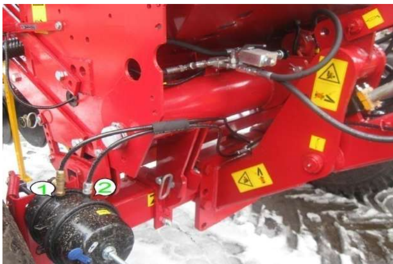
Рис. 22а - Тормозная камера с пружинным энергоаккумулятором
