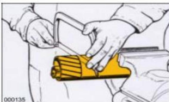
– Равномерно укоротить внутреннюю и внешнюю защитную трубу.
