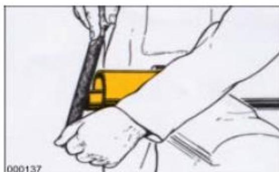
– Закруглить разделительные кромки и тщательно удалить стружки. Очистить и смазать сдвижные профили.
