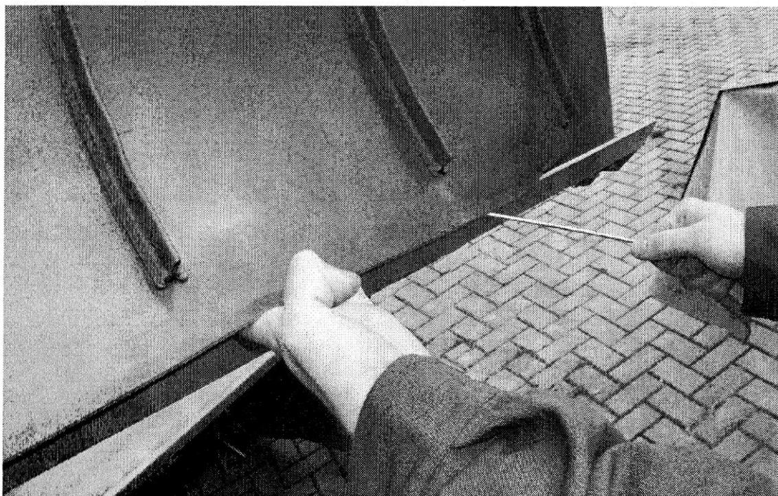
Рис. 35 Очистка загрязнений внутри ленты транспортера
