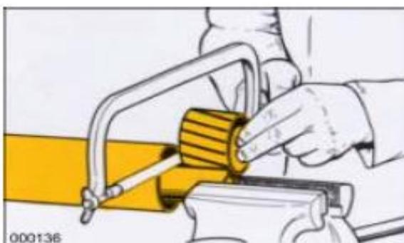
– Укоротить внутренний и внешний сдвижной профиль на ту же длину, что и защитная труба.
