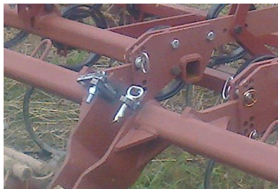
Рис. 3.10- Фиксатор рабочих секций «S». В рабочем положении разомкнут, в транспортном - замкнут
