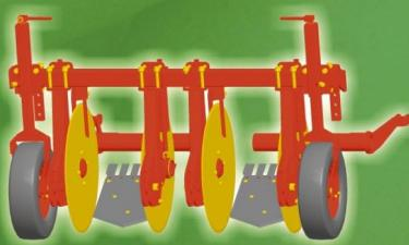
Предназначен для выкапывания лука и столовой свеклы с предварительно удаленной ботвой на междурядьях 70 см.
