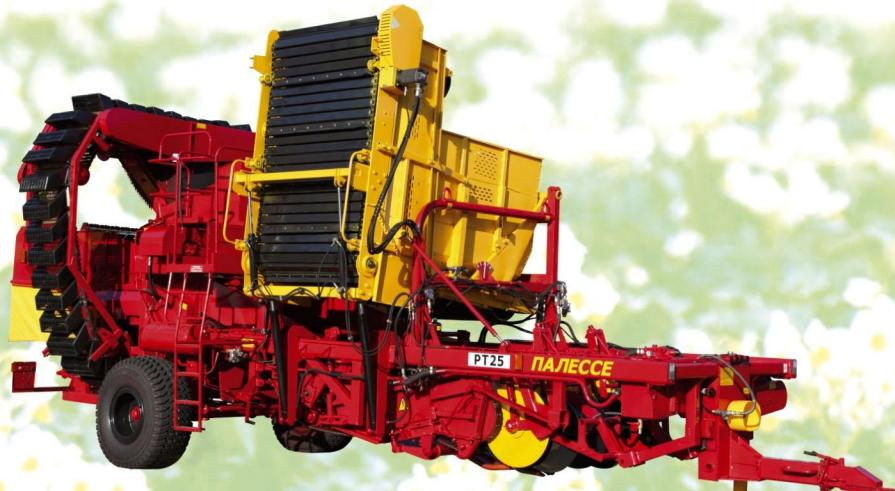
Комбайны ПКК-2-05 и ПКК-2-03 предназначены для уборки картофеля на легких и средних почвах, отделением его от примесей и накопления в бункере с последующей выгрузкой. Возможно изготовление комбайн ПКК-2 (копатель-погрузчик) без бункера с выгрузным транспортером.
