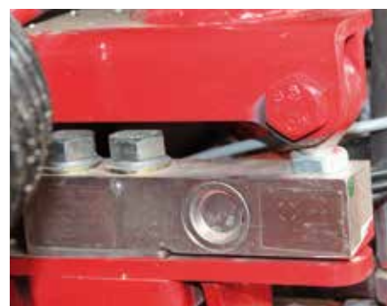
Весовая система состоит из 4-х тензодатчиков под бункером и...
