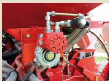
Электрогидравлический привод дозаторов
